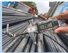
钢筋进场验收
