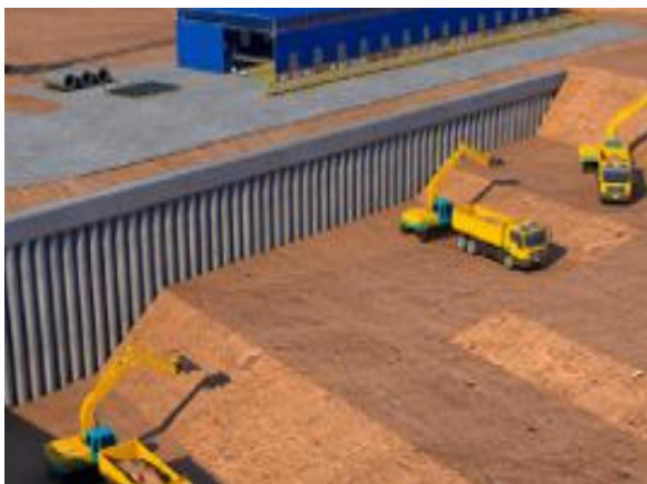
基坑分区分层开挖
