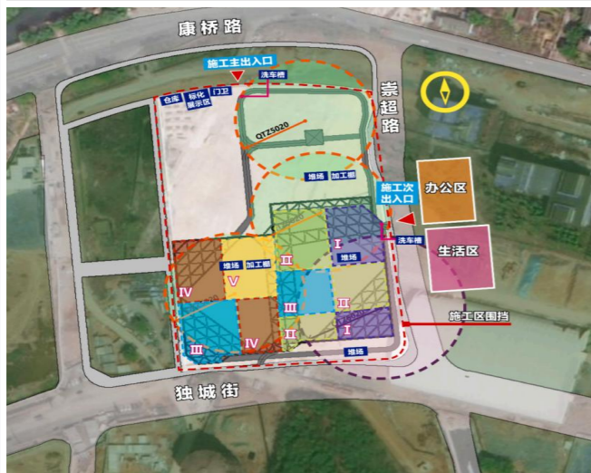
塔吊覆盖范围
