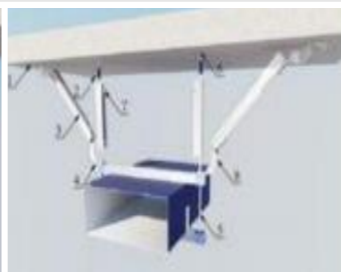
风管侧向支架
