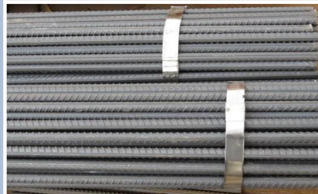
钢筋进场后，必须在24小时内完成报验、见证取样、见证送检，送检结果未出来前不得使用，原材料就地封存处理。
