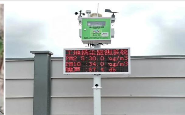
扬尘噪音检测
