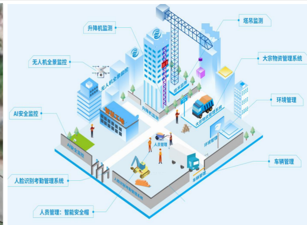
智慧工地管理系统
