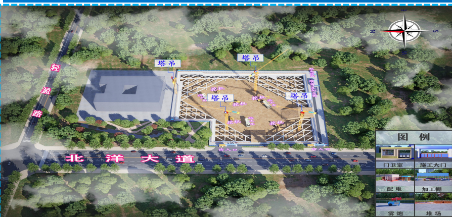
基坑开挖阶段平面布置BIM图
