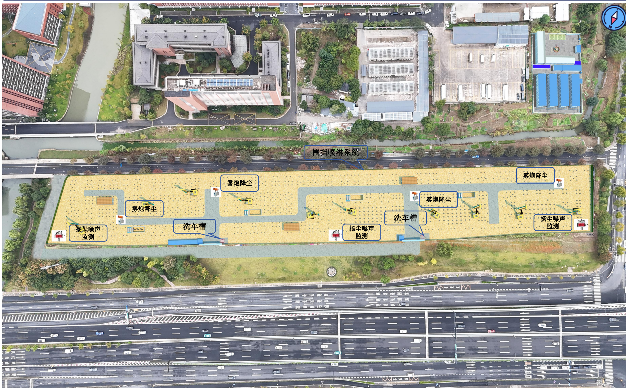
桩基阶段标化工地现场安全文明施工布置
