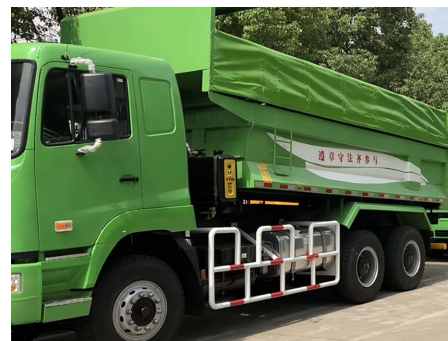
渣土覆盖运输
