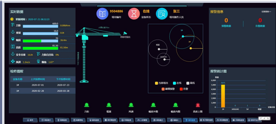
塔吊实时监控
