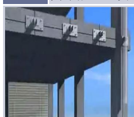
角码安装复查
