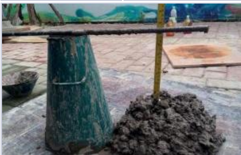
混凝土进场验收示意图
