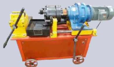
钢筋套丝示意图
