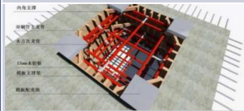
集水井、电梯基坑吊模示意图
