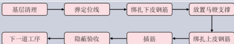
底板钢筋施工工艺流程图
