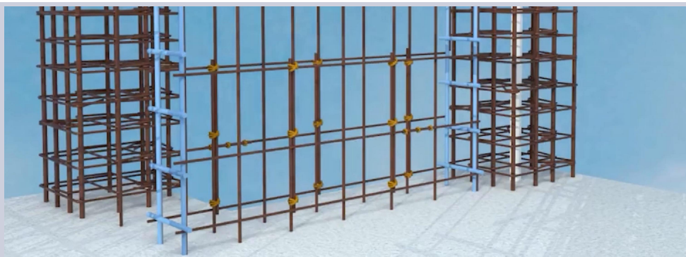
墙钢筋安装示意图
