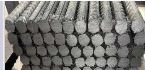
钢筋切断示意图
