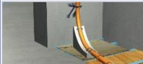
水平泵管与竖向泵管连接示意图
