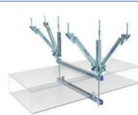
风管支吊架制作
