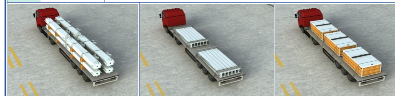
箱型构件用钢带绑扎，构件间采用垫木隔开 H 型钢梁捆装，钢带绑扎，梁与梁采用垫木隔开 连接板、高强螺栓等零部件，装箱
