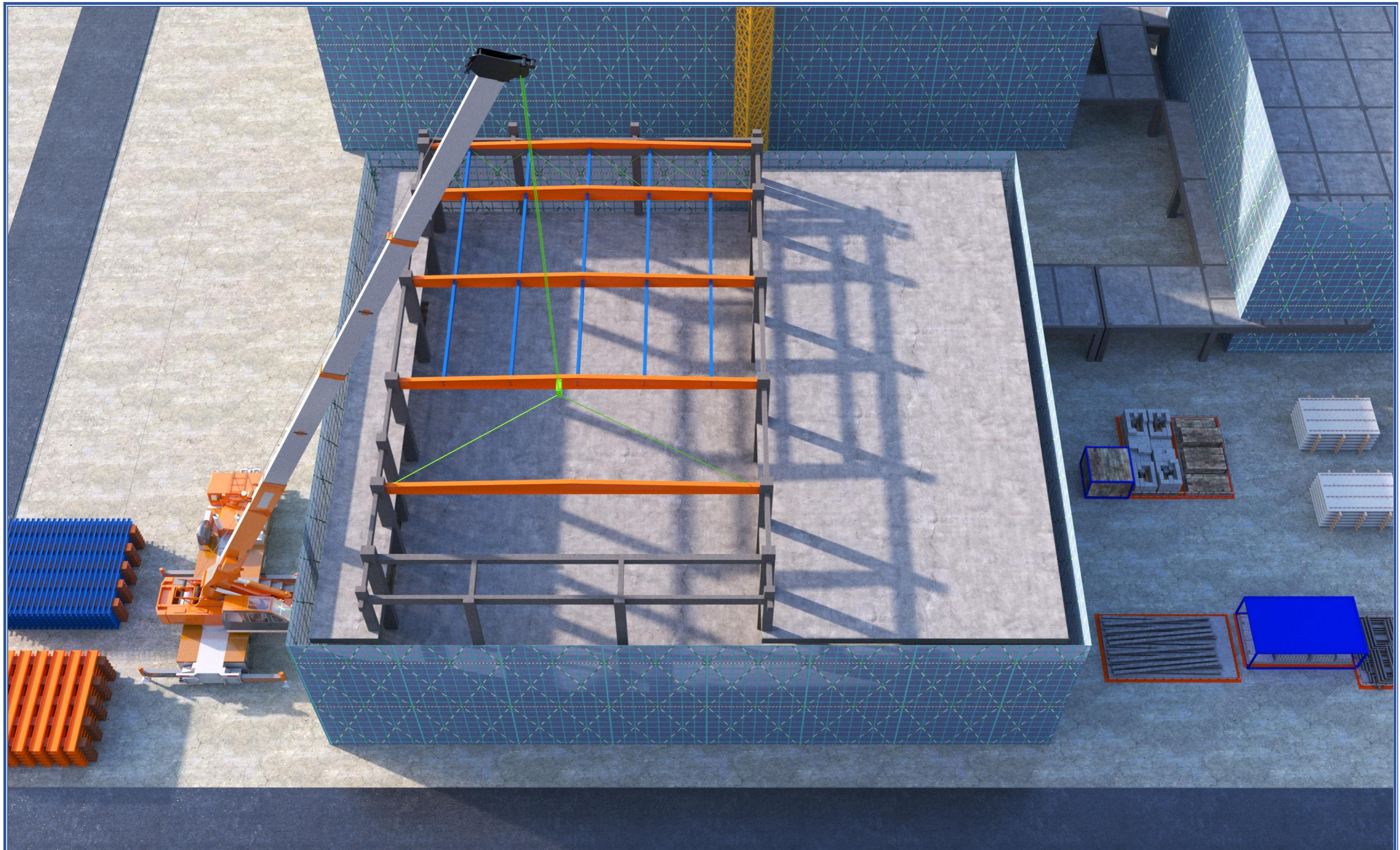
F 轴钢梁吊装,C-D 轴屋面结构施工
