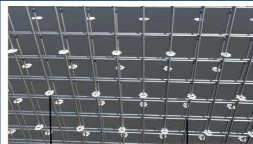
PVC钢筋保护层垫块 (足够硬度，背向模板方向) 钢筋 (间距允许偏差10mm，保护层厚度允许偏差3mm)
