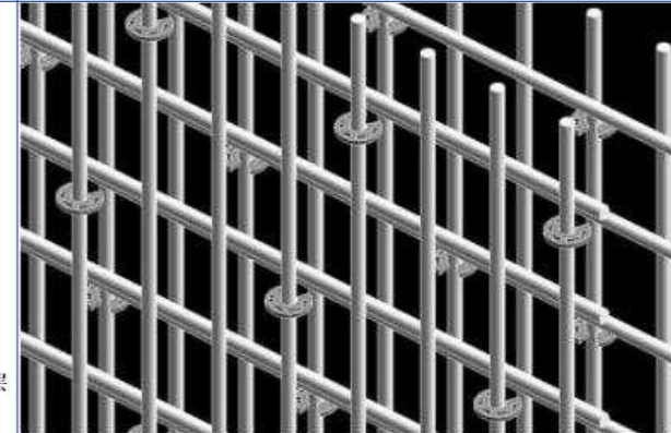
墙钢筋塑料卡安装
