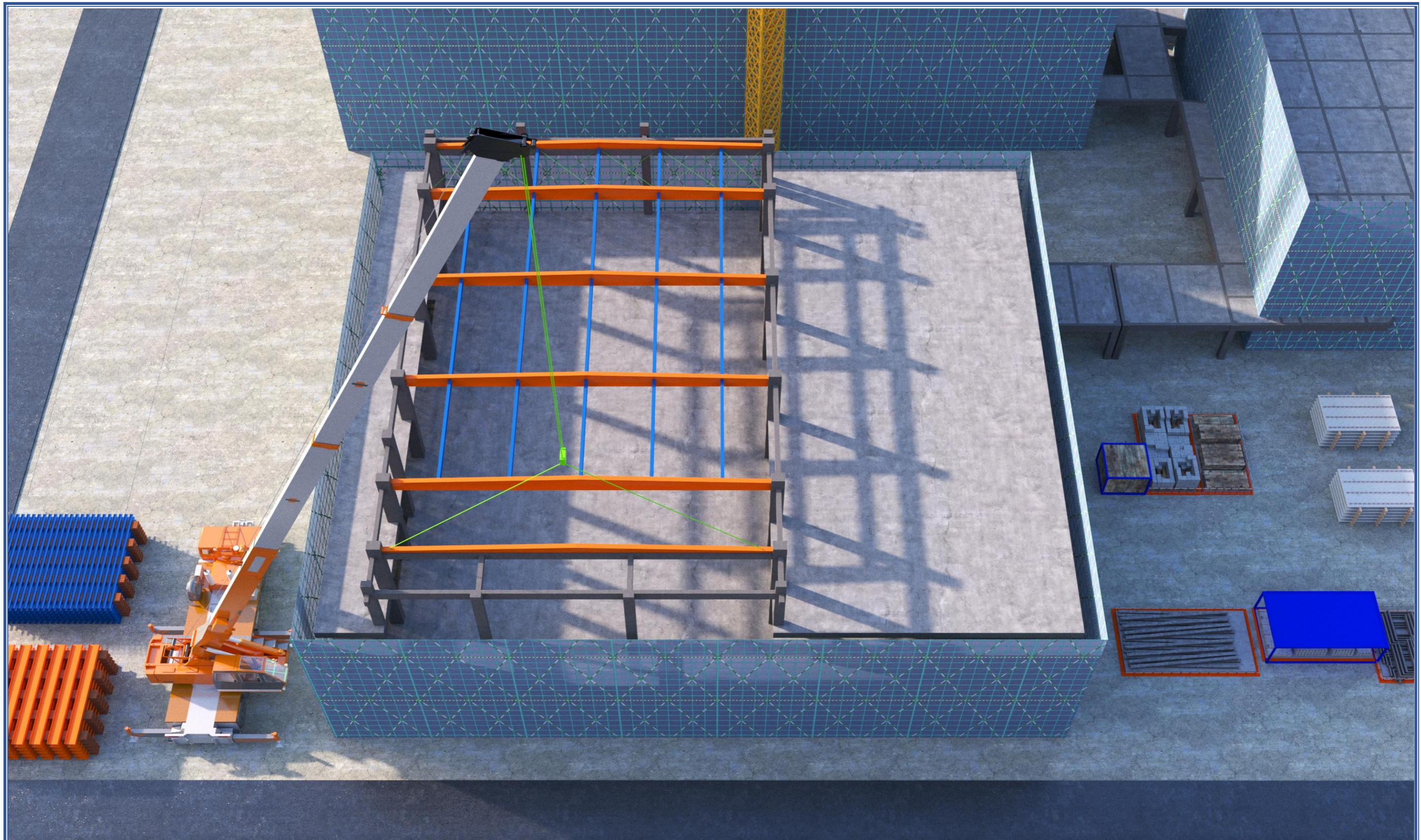
G 轴钢梁吊装,D-F 轴屋面结构施工
