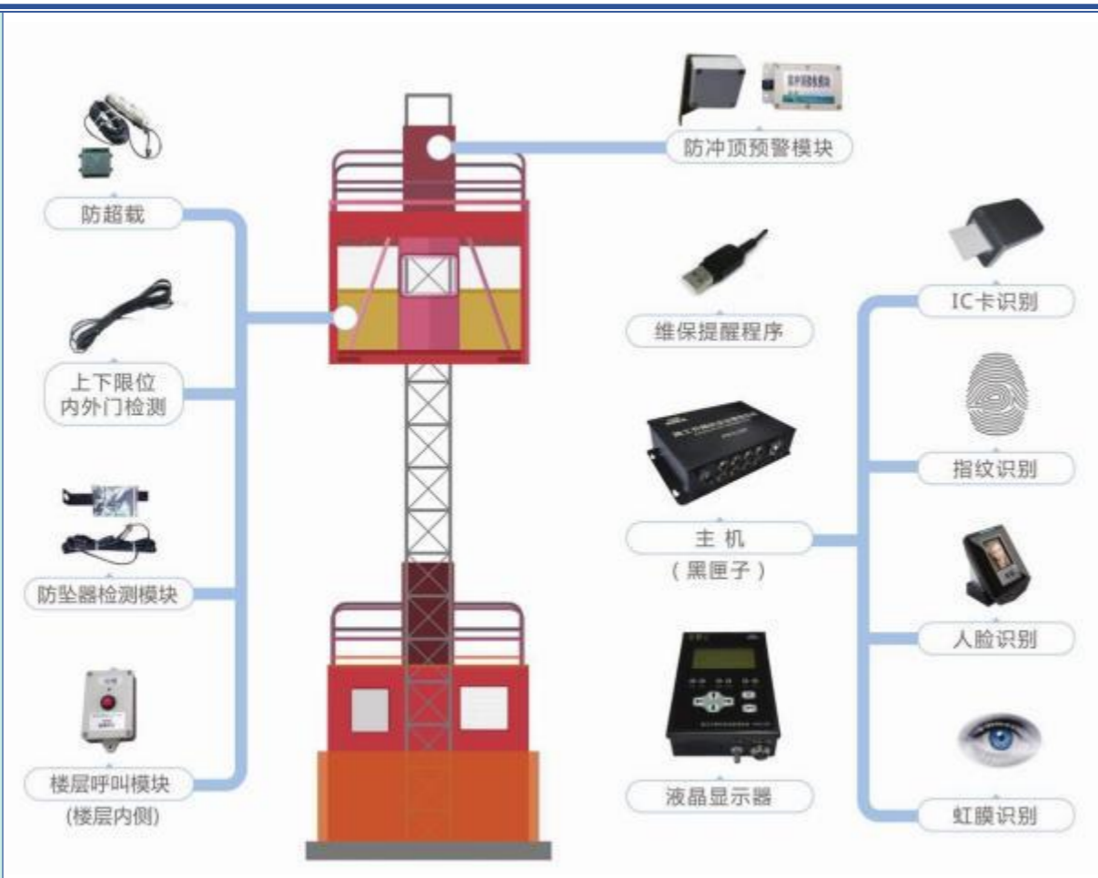
施工电梯监控
