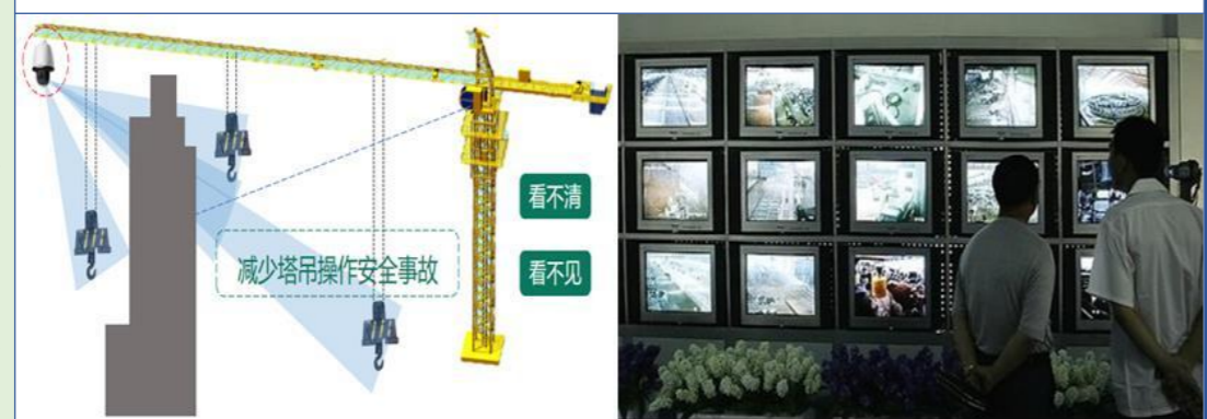
塔吊安全监控系统
