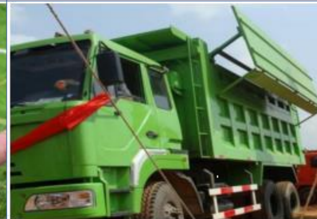
土方车辆采用封闭式车辆
