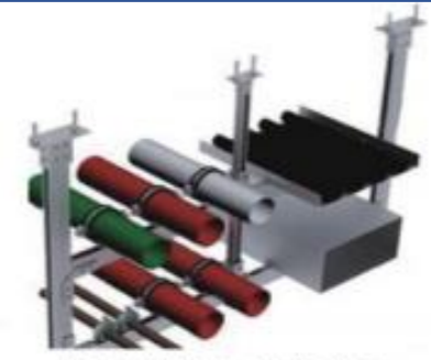
机电管线综合支吊架体系
