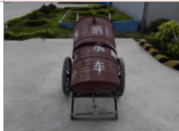
施工现场洒水降尘
