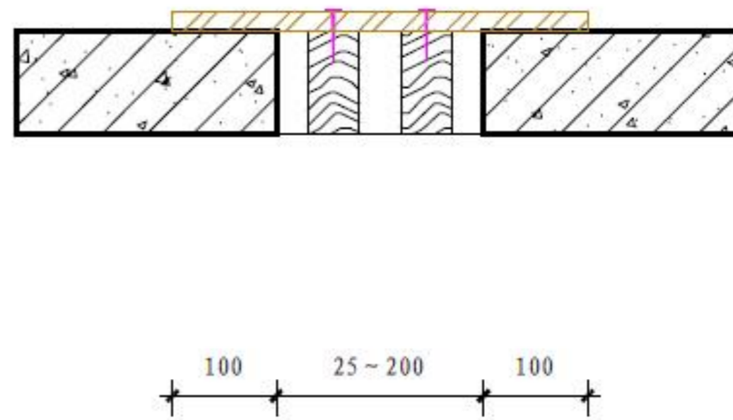
图：边长在 25~200mm 的水平洞口防护剖面图
