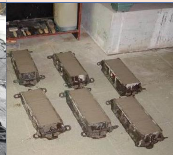
混凝土试块制作
