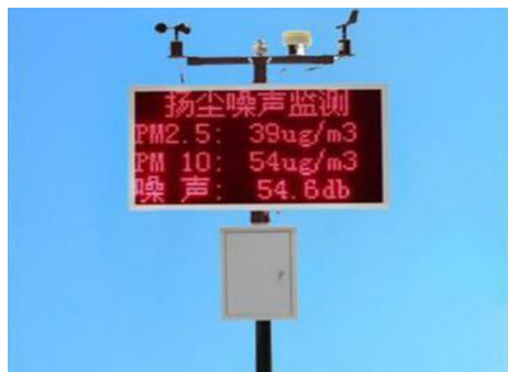
扬尘噪音监测
