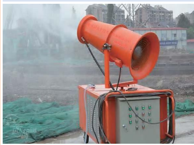
工地扬尘控制
