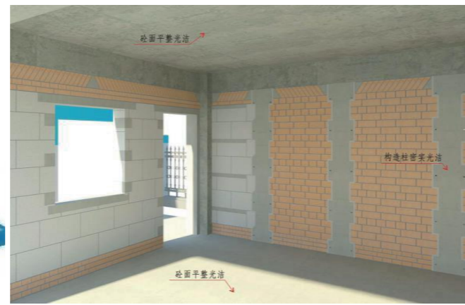
BIM 技术进行三维可视化交底
