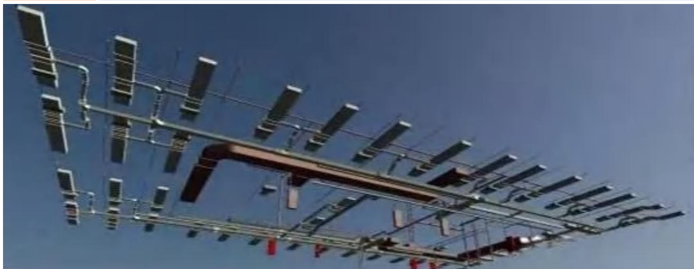
管道碰撞BIM检查
