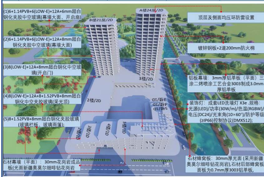
各部位幕墙施工及材料规格示意图
