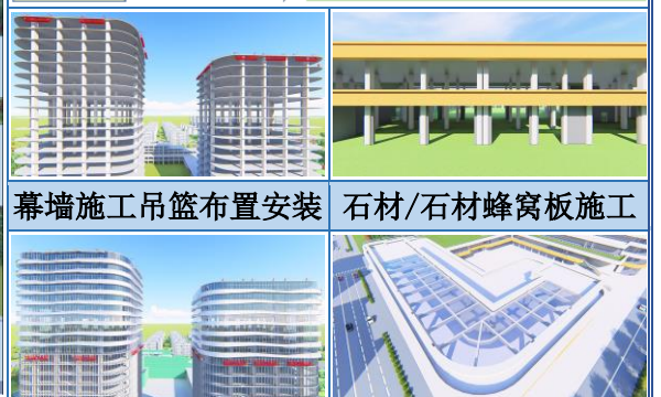
玻璃幕墙自上而下施工
