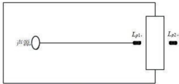
图 4-1 室内声源等效为室外声源图例
